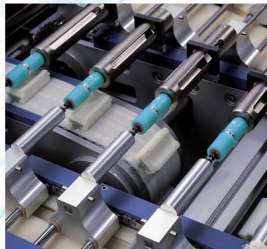
BRECO-Zahnriemenschluss in der Ausführung AT 10 DC.
