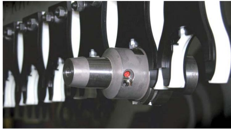
Werkzeughalterleiste mit eingespanntem Werkzeug (Detail).
