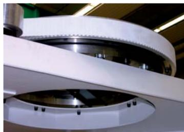
Insbesondere im Bereich des Werkzeugwechsels bietet die MFZ-Baureihe nicht zuletzt dank ihres hochpräzisen Zahnriemenantriebs Vorteile gegenüber Kettenmagazinen, weil ihre konstruktive Auslegung mit einer Reduzierung der beweglichen Elemente einhergeht.
