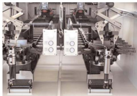
2-Ketten Werkzeugmagazin des Bearbeitungszentrums GS 1000 von Alzmetall.
