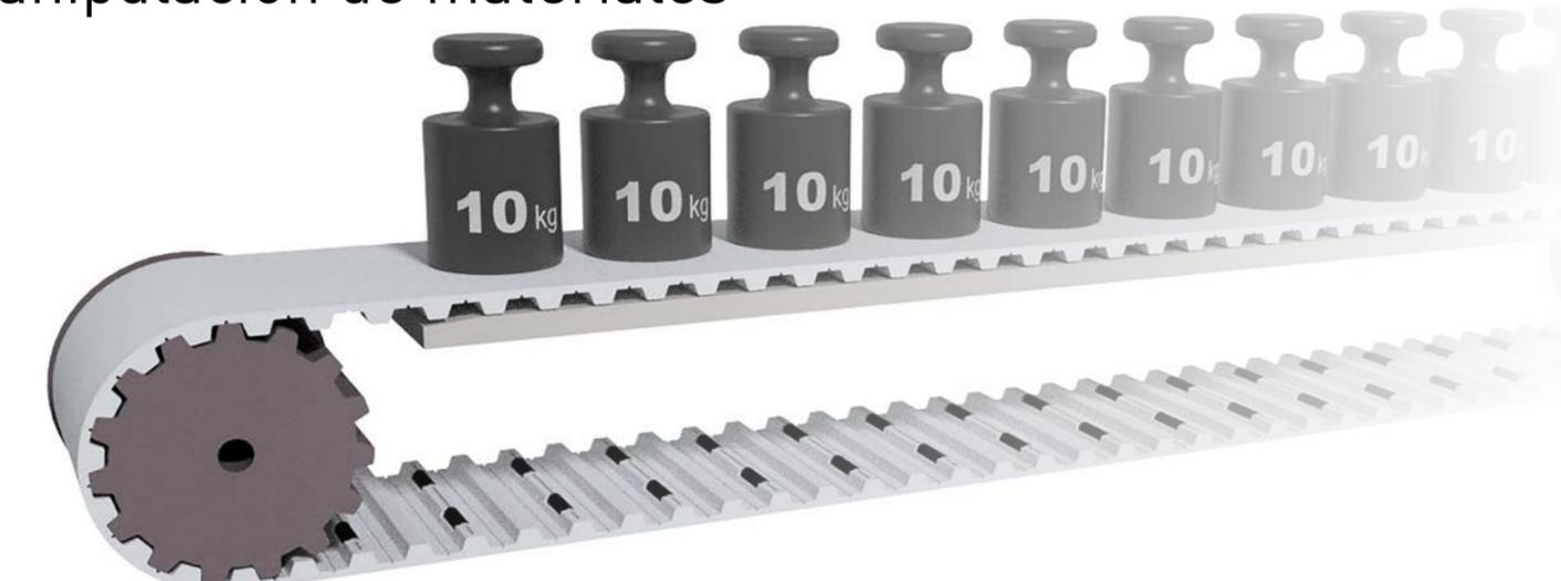
Por lo tanto, las correas dentadas para el transporte de materiales se recubren en serie con un tejido en el lado del diente. Esto reduce el coeficiente de fricción entre la correa dentada y el carril de soporte de  $\mu = \pm 1,0$  a  $\mu = 0,5$  a  $0,6$ .
